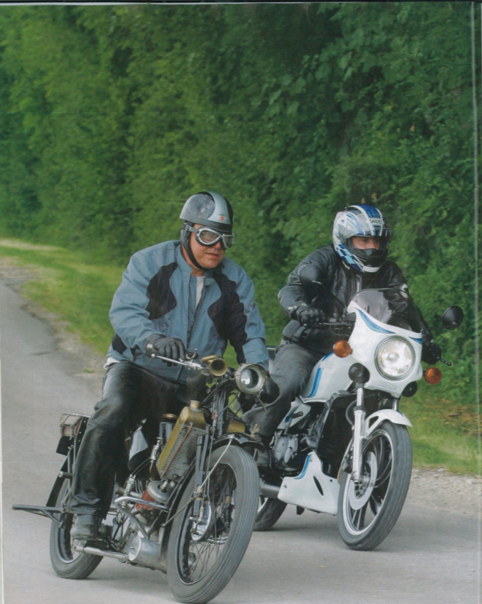
Le cadre de l'anglaise, constitué d'un treillis de tubes sans aucune courbe est d'une grande rigidité pour l'époque. Calé à 180°, avec un piston au point mort haut pendant que l'autre est au point mort bas, le moteur est exempté des vibrations typiques des twins anglais. La Scott disposait là aussi d'une avance sur la concurrence.
